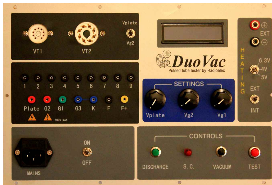
Exemple d'un lampemètre prêt à l'emploi réalisé avec ce module. Cet appareil possède une matrice d'interconnexion pour l'adaptation de divers brochages de tubes.
